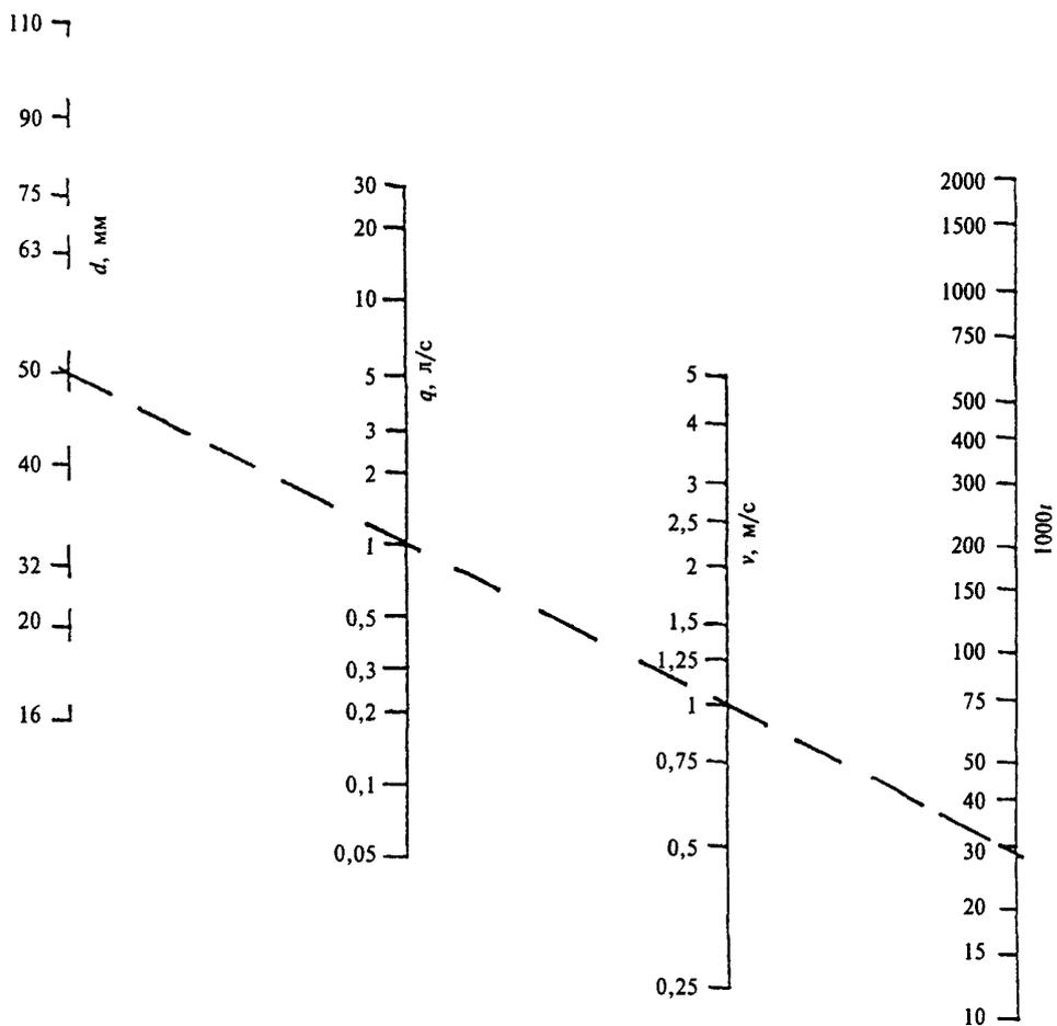
$d$  - расчетный диаметр;  $q$  - расчетный расход воды;
