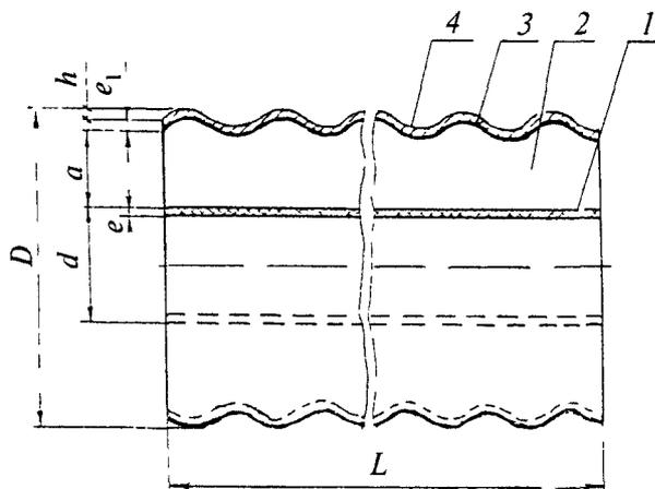
1 - труба ПЭ-С; 2 - пенополиуретан;
